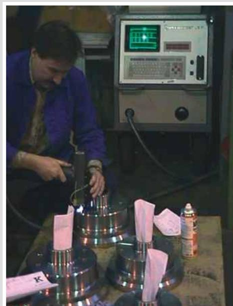
Die Überwachung der Schweißqualität erfolgt durch nach EN 473 zertifizierte ZfP Prüfer
